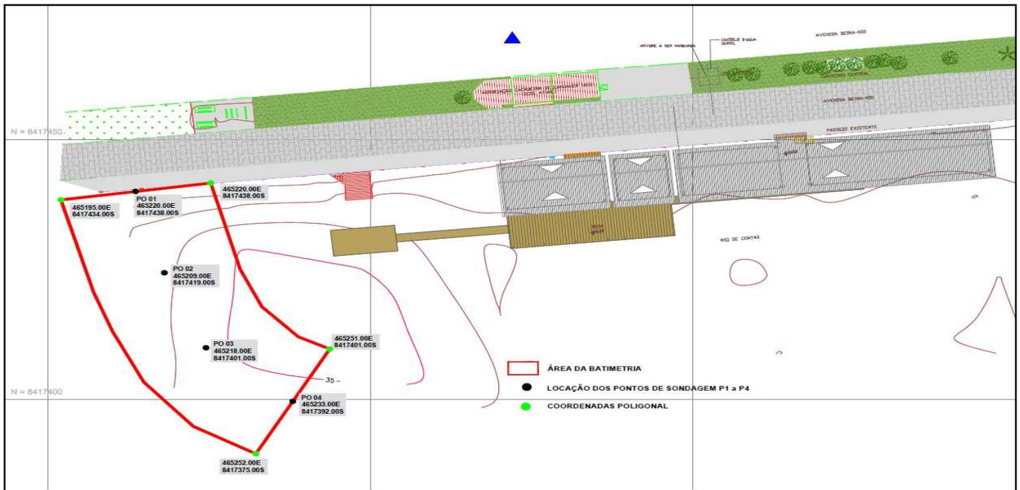
IMAGEM: Representação da poligonal da **Batimetria no Rio de Contas** a ser estudada, com a previsão da área e pontos desondagem.
